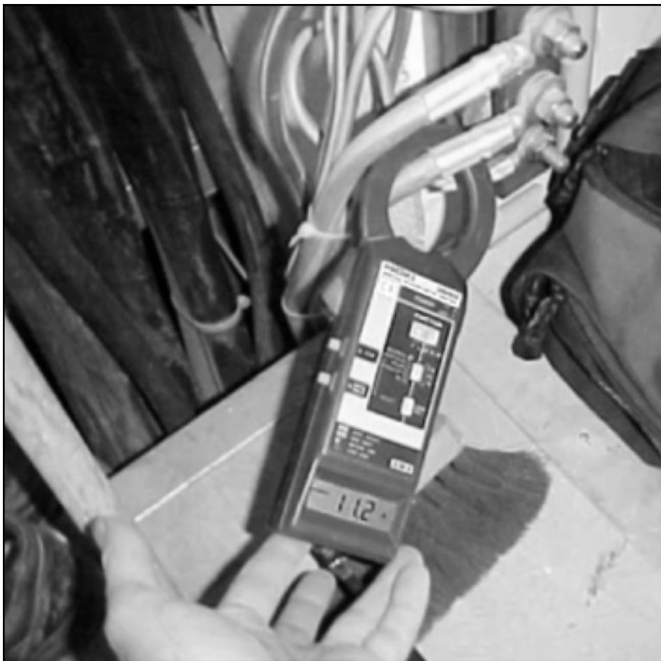
Bild 2 11,2 A Neutralleiterstrom 150 Hz auf Erdungssystem
